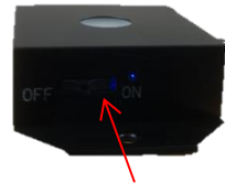
d) Probe 전원 On/Off 슬라이드 스위치 Probe Power On/Off Slide Switch
