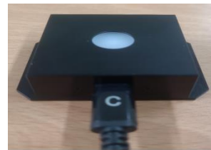
g) 제품과 함께 제공하는 USB A to C type 케이블을 사용하여 리튬폴리머 충전배터리 충전 Charging lithium polymer rechargeable battery using the USB A to C type cable provided with the product
